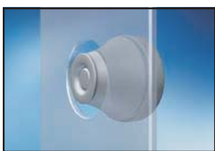
Push the grommet into the hole. 将电缆密封环推入孔中。
