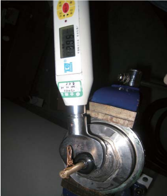
电缆接头夹紧扭矩测试 test for torque moment EN50262
